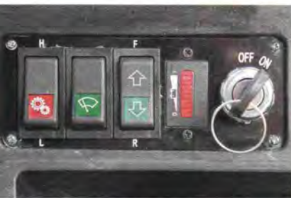
Energiespeicher und Schaltzentrale. Beim E-UTV wählt der Fahrer per Schalter aus, ob er Vor- oder Rückwärts fahren möchte
